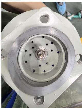
4. Instale el respirador en el puerto del tubo de respiración, apriete los tornillos en diagonal e instale la junta de sellado como se muestra en la figura siguiente
