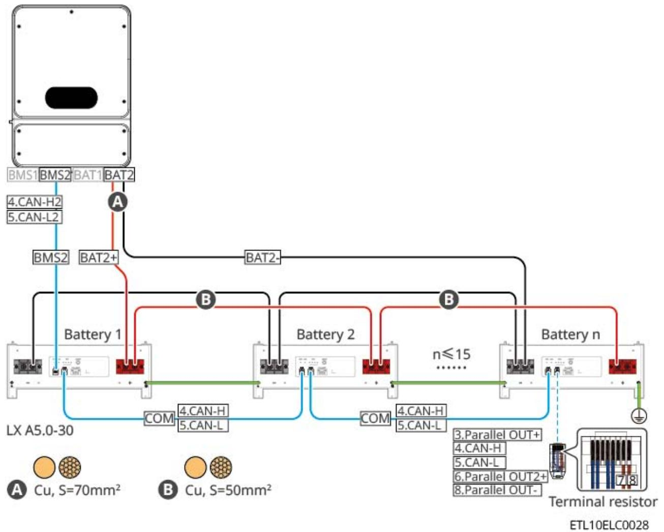
LX A5.0-30: Cuando se conectan dos Batería a un Inversor de salida dual, el diagrama de conexión es el siguiente:
