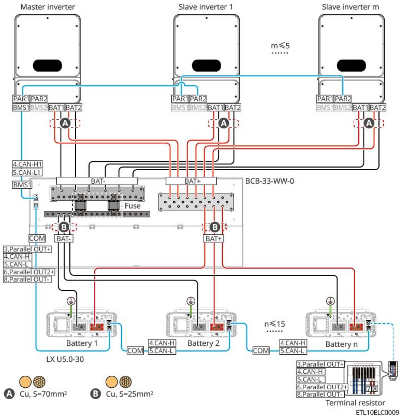
LX U5.0-30: Cuando la cantidad de Batería sea  $\leq 8$  unidades, Batería se combina con el método de conexión de busbar de terceros.
