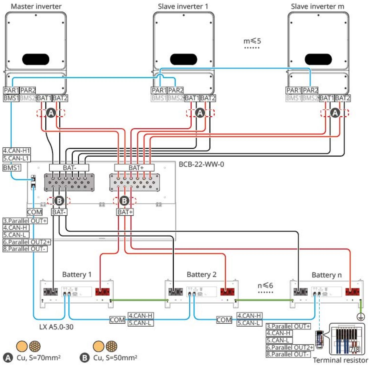
LX A5.0-30: Compatible con el método de conexión de barras colectoras BCB-32-WW-0, el diagrama de conexión es el siguiente:
