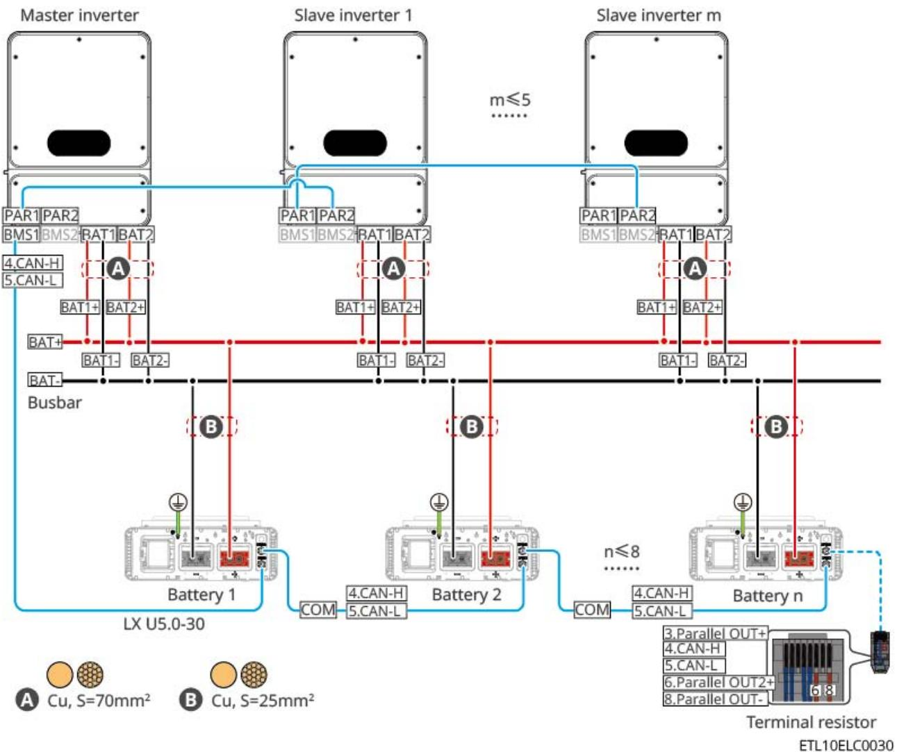
LX U5.0-30: Cuando la cantidad de Batería sea >8 unidades, el Batería se combinará con el método de conexión de busbar de terceros.
