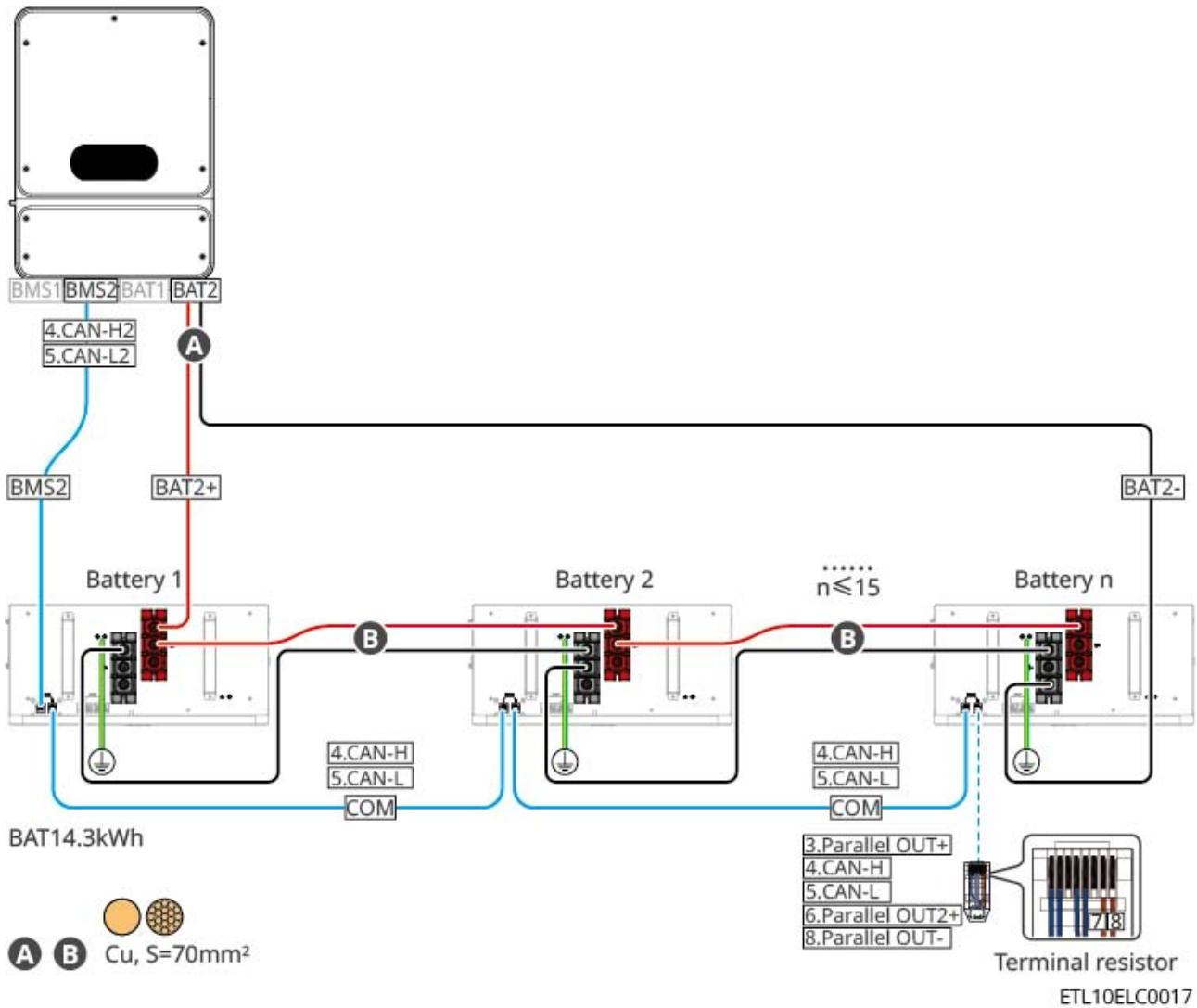
GW14.3-BAT-LV-G10: Conexión de un solo circuito Batería a un único inversor de doble salida Inversor.
