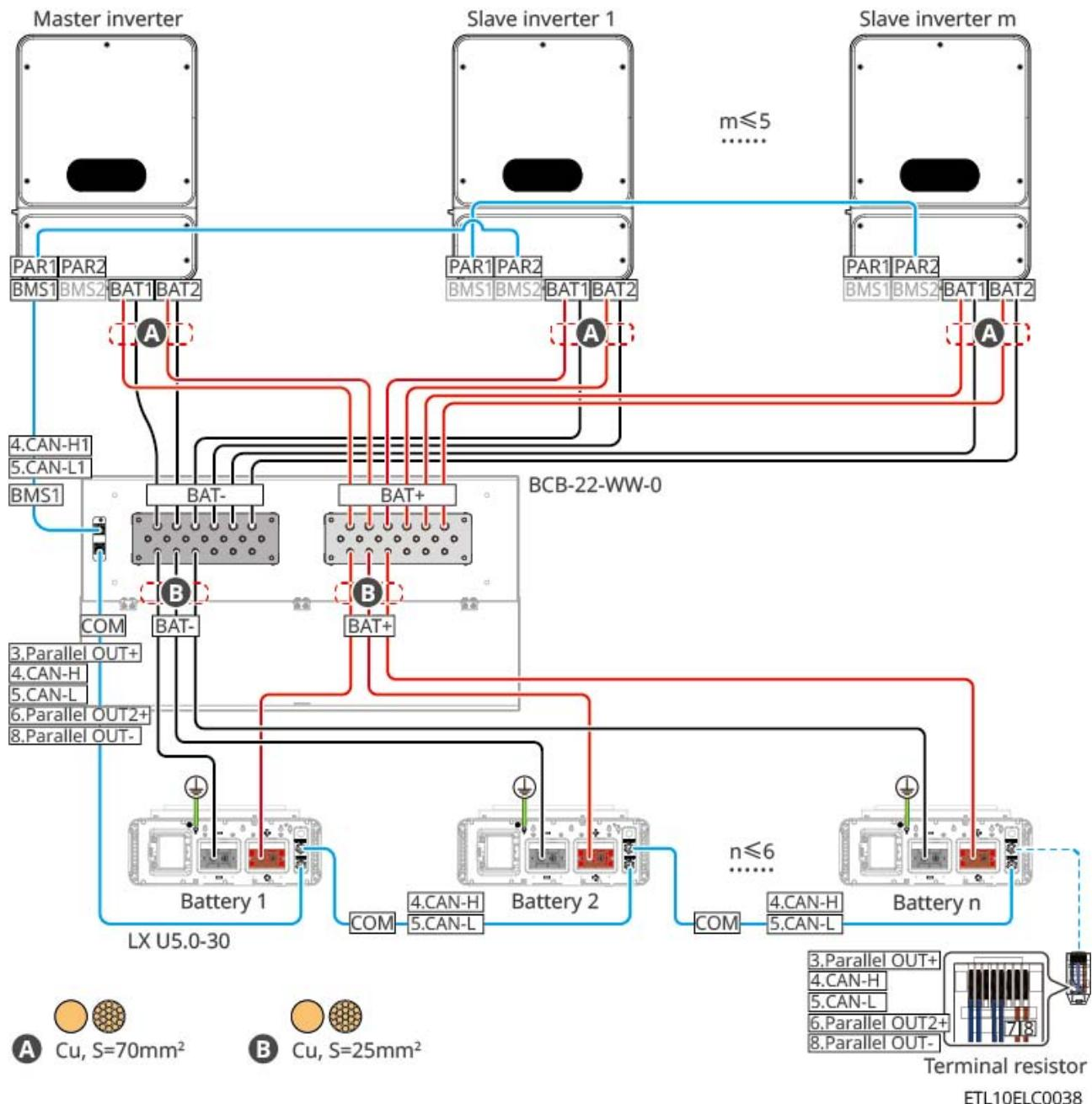
LX U5.0-30: Cuando la cantidad de Batería sea  $\leq 8$  unidades, el Batería se combina con el método de conexión BCB-32-WW-0.
