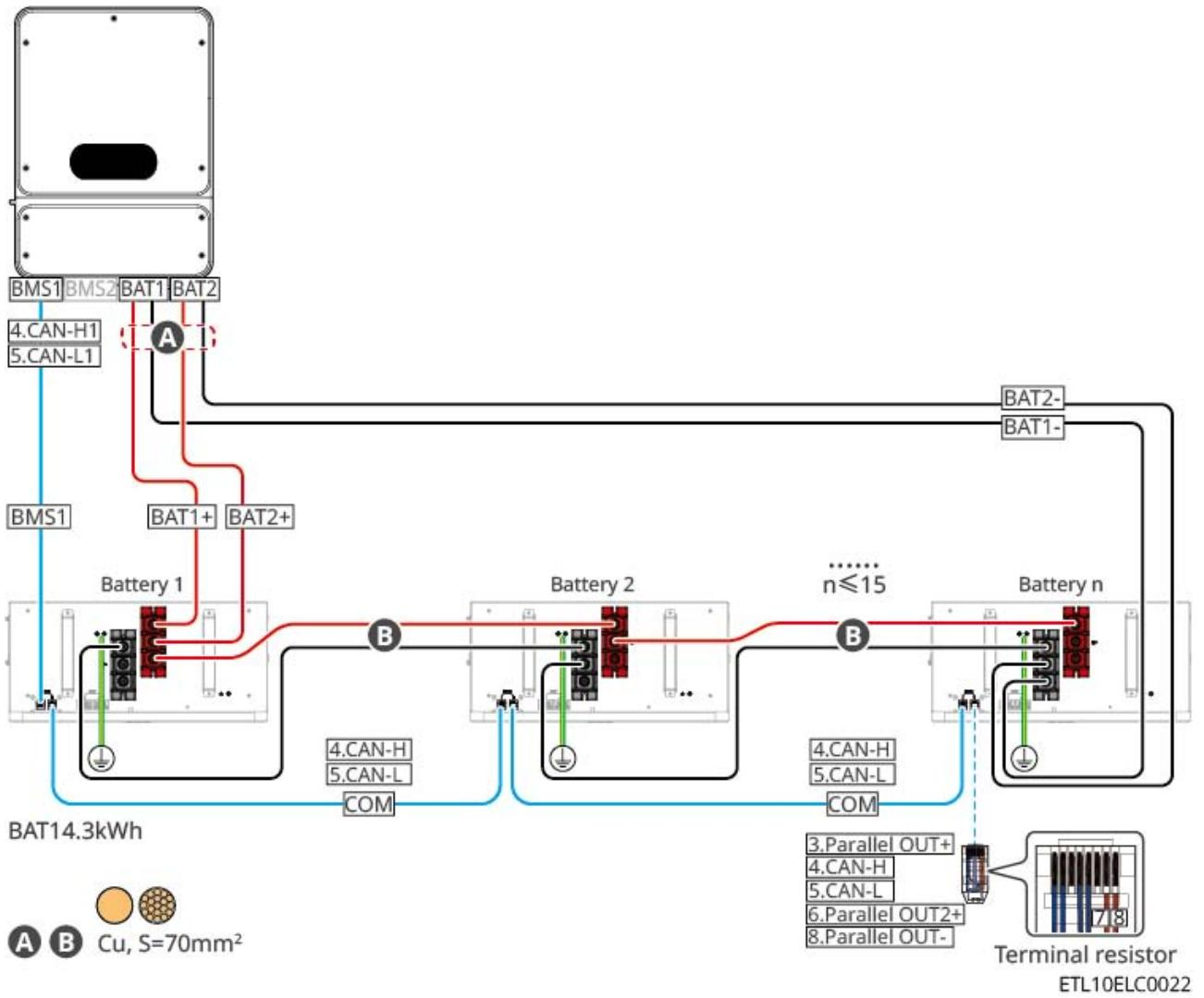
GW14.3-BAT-LV-G10: Conexión de doble vía Batería a un único Inversor con salida de 2 vías
