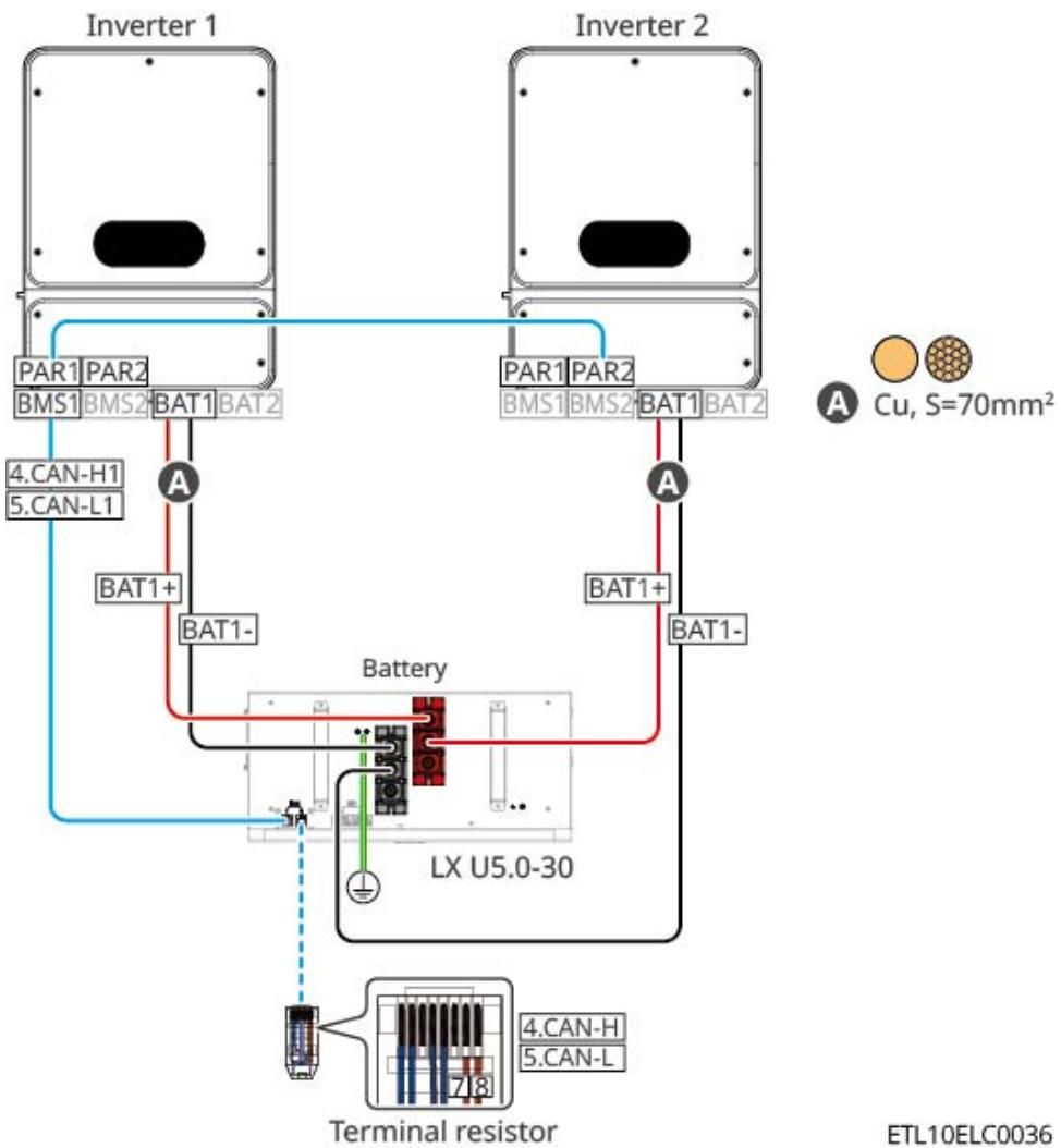
GW14.3-BAT-LV-G10: Cuando la cantidad de Batería es menor o igual a 15, y se utiliza un busbar (BCB-32-WW-0, corriente  $\leq 720\text{A}$ ) para conectar Inversor:
