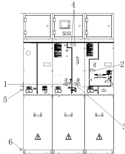
Figure 2-17 Ring main unit DQS-40.5 DVC appearance
