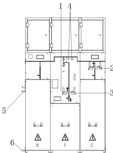
Figure 2-16 Ring main unit DQS-24 DVC appearance
