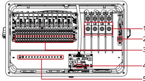
1. Terminal de salida de CA    2. Terminal PE (GND)    3. Terminal de entrada de CC<sup>[1]</sup>
