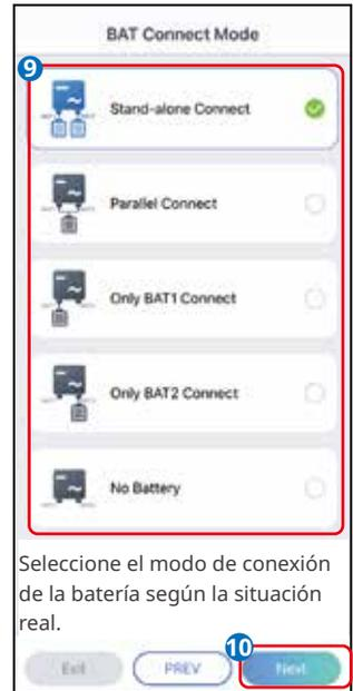
Seleccione el modo de conexión de la batería según la situación real.
