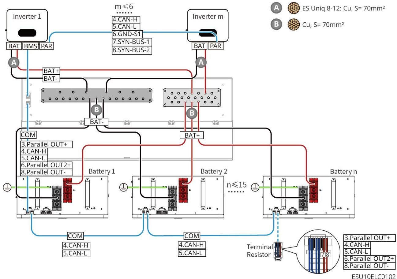
GW14.3-BAT-LV-G10: Cuando el número de baterías es menor o igual a 30, usando busbar de terceros para conectar el inversor de salida de 1 vía, el diagrama de conexión es el siguiente:
