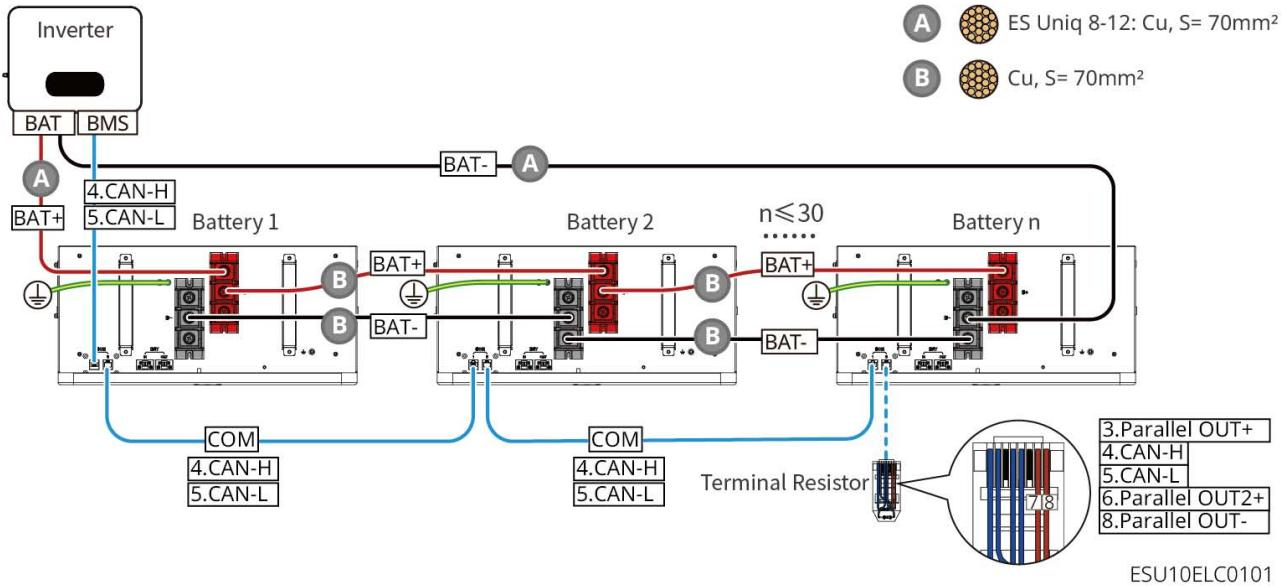
GW14.3-BAT-LV-G10: Cuando el número de baterías es menor o igual a 15, usando el busbar (BCB-32-WW-0, corriente ≤720A) para conectar el inversor de salida de 1 vía, el diagrama de conexión es el siguiente:
