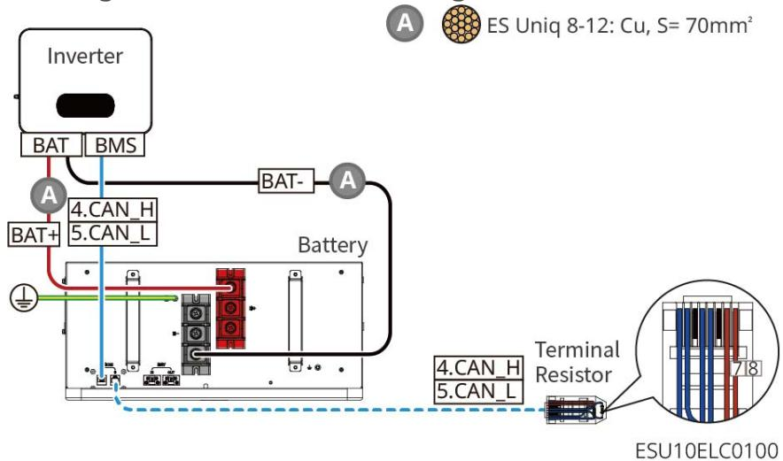
GW14.3-BAT-LV-G10: Cuando la batería se conecta directamente a 2 inversores de salida de 1 vía, el diagrama de conexión es el siguiente:
