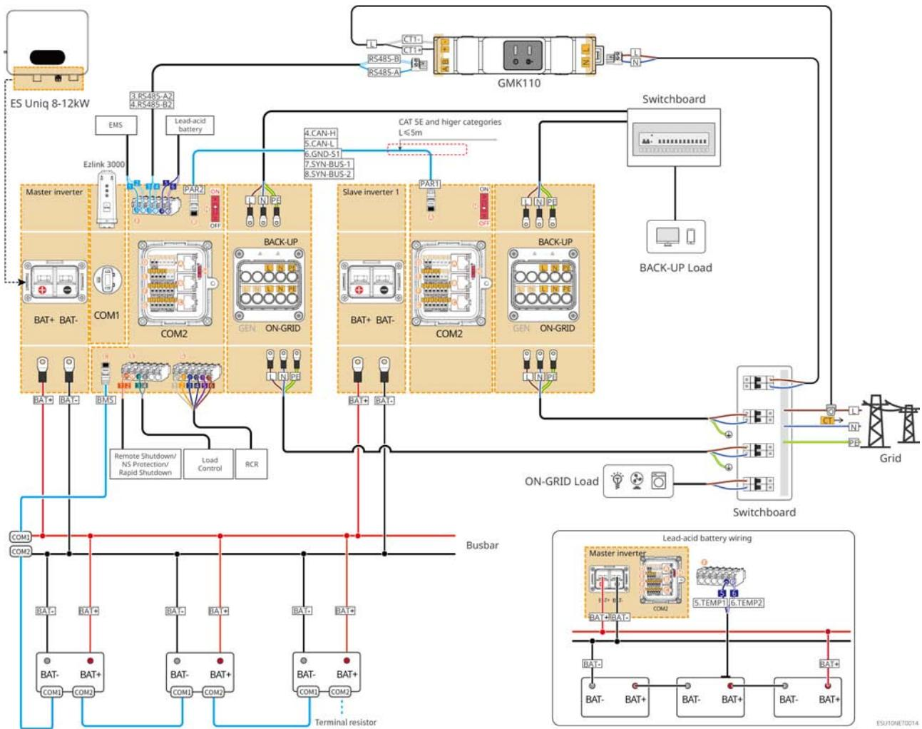
**Modo de conexión no bus de baterías cuando los inversores están en paralelo**
