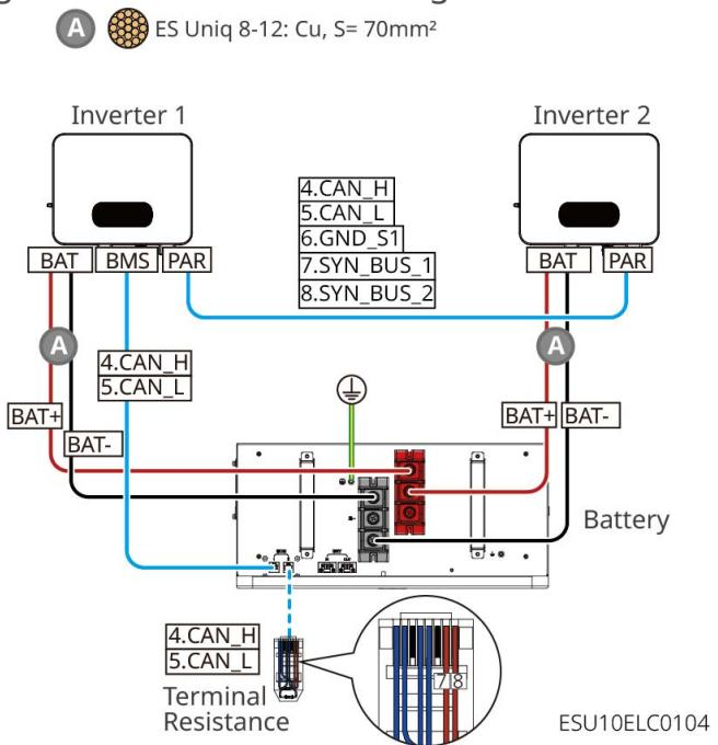
GW14.3-BAT-LV-G10: Cuando la batería se conecta en cadena a un inversor de salida de 1 vía, el diagrama de conexión es el siguiente:
