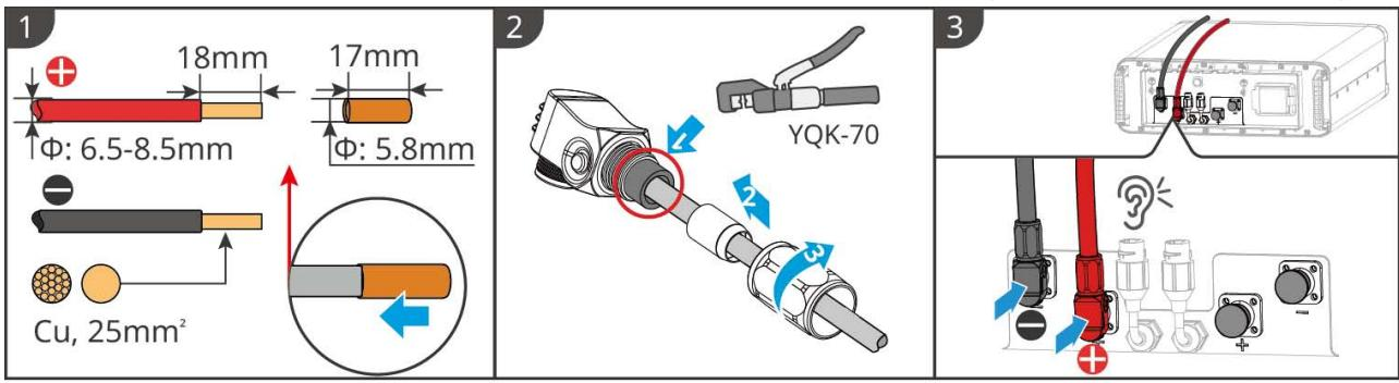
Método de fabricación del cable en el extremo de la batería (LX U 5.0-30)
