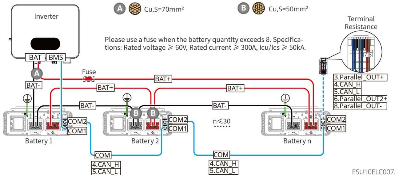
LX U5.0-30: Cuando el número de baterías ≤6, modo de conexión de la batería con BCB-22-WW-0
