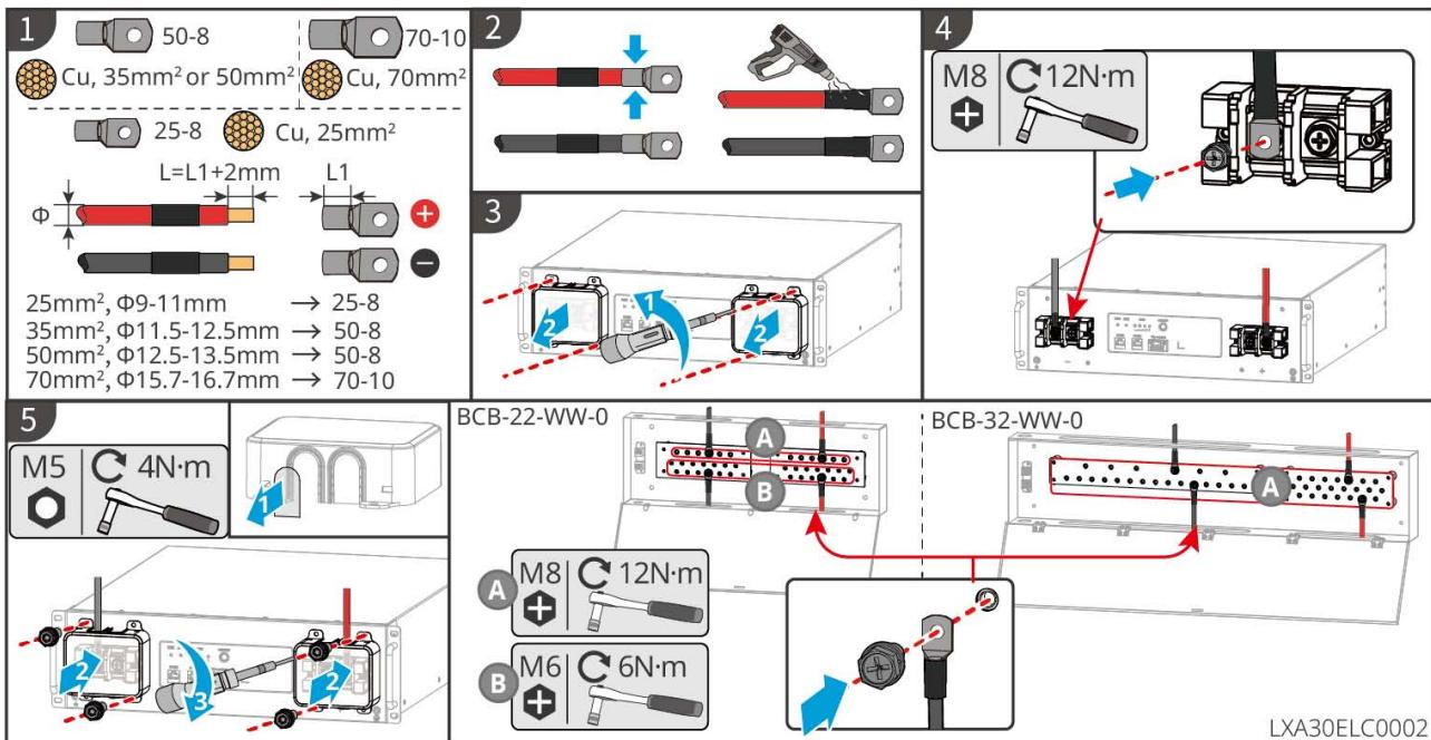
Método de fabricación del cable en el extremo de la batería (LX U5.4-L, LX U5.4-20)
