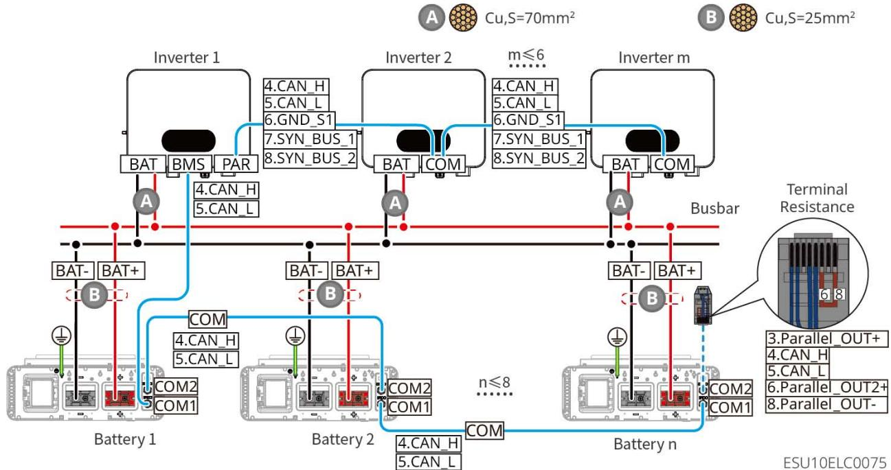
LX U5.0-30: Cuando el número de baterías es mayor a 8, modo de conexión de la batería con busbar de terceros
