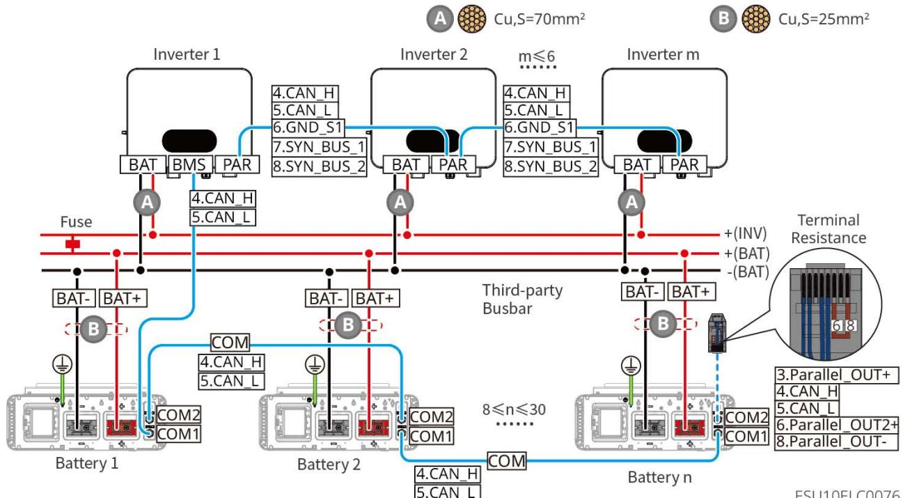
GW14.3-BAT-LV-G10: Cuando la batería se conecta directamente a un inversor de
