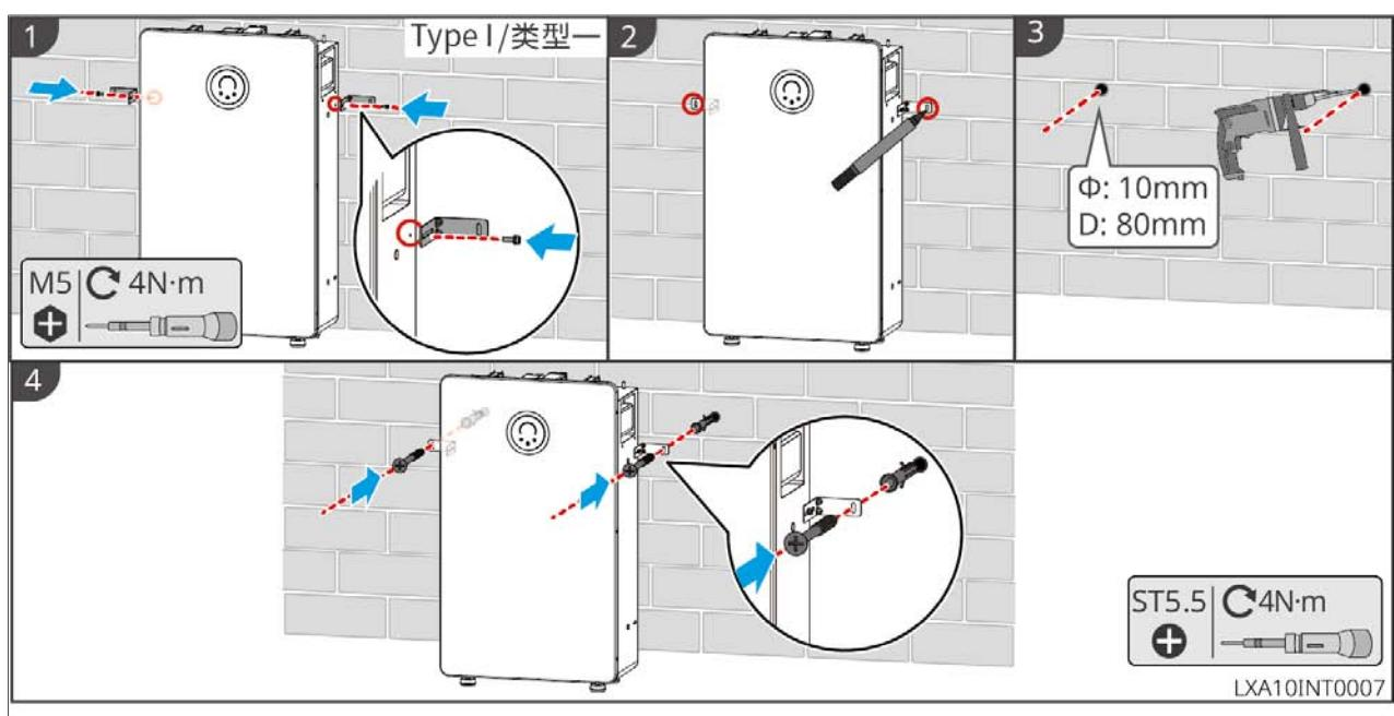
GW14.3-BAT-LV-G10: Instalación montado en pared
