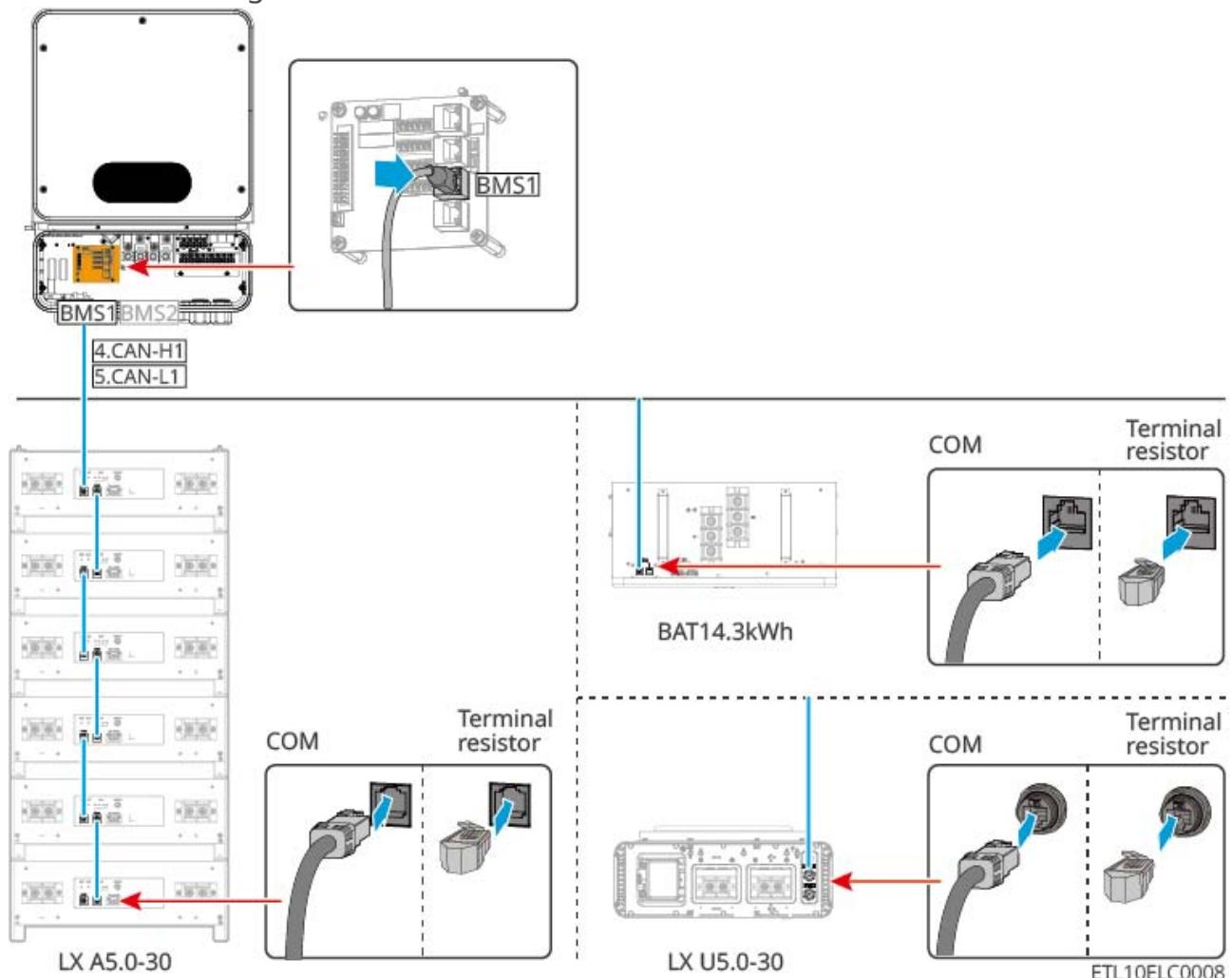
Diagrama de comunicación de conexión entre BMS1 y BMS2:
