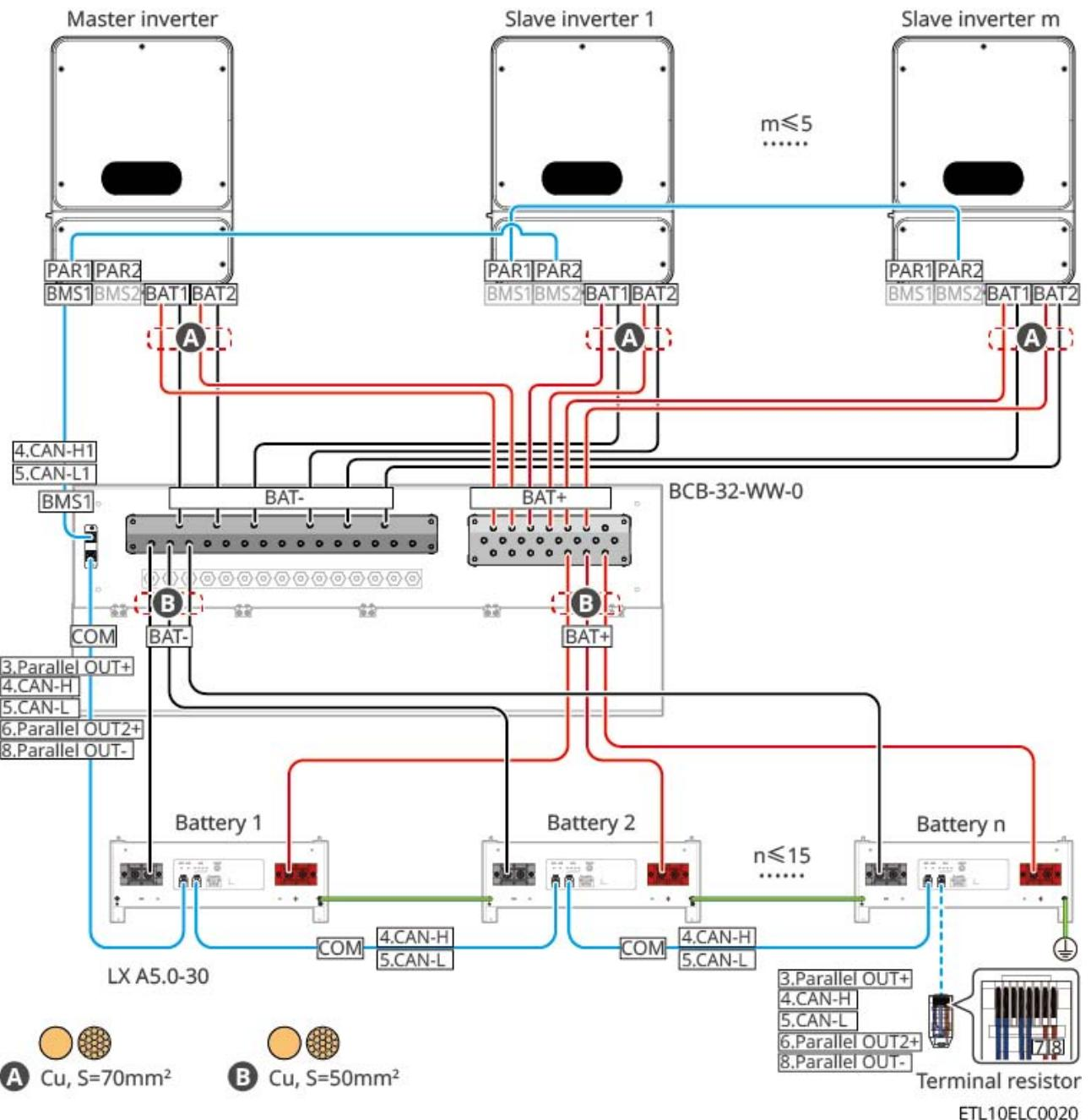
LXA5.0-30: Compatible con el método de conexión de busbar de terceros, el diagrama de conexión es el siguiente:
