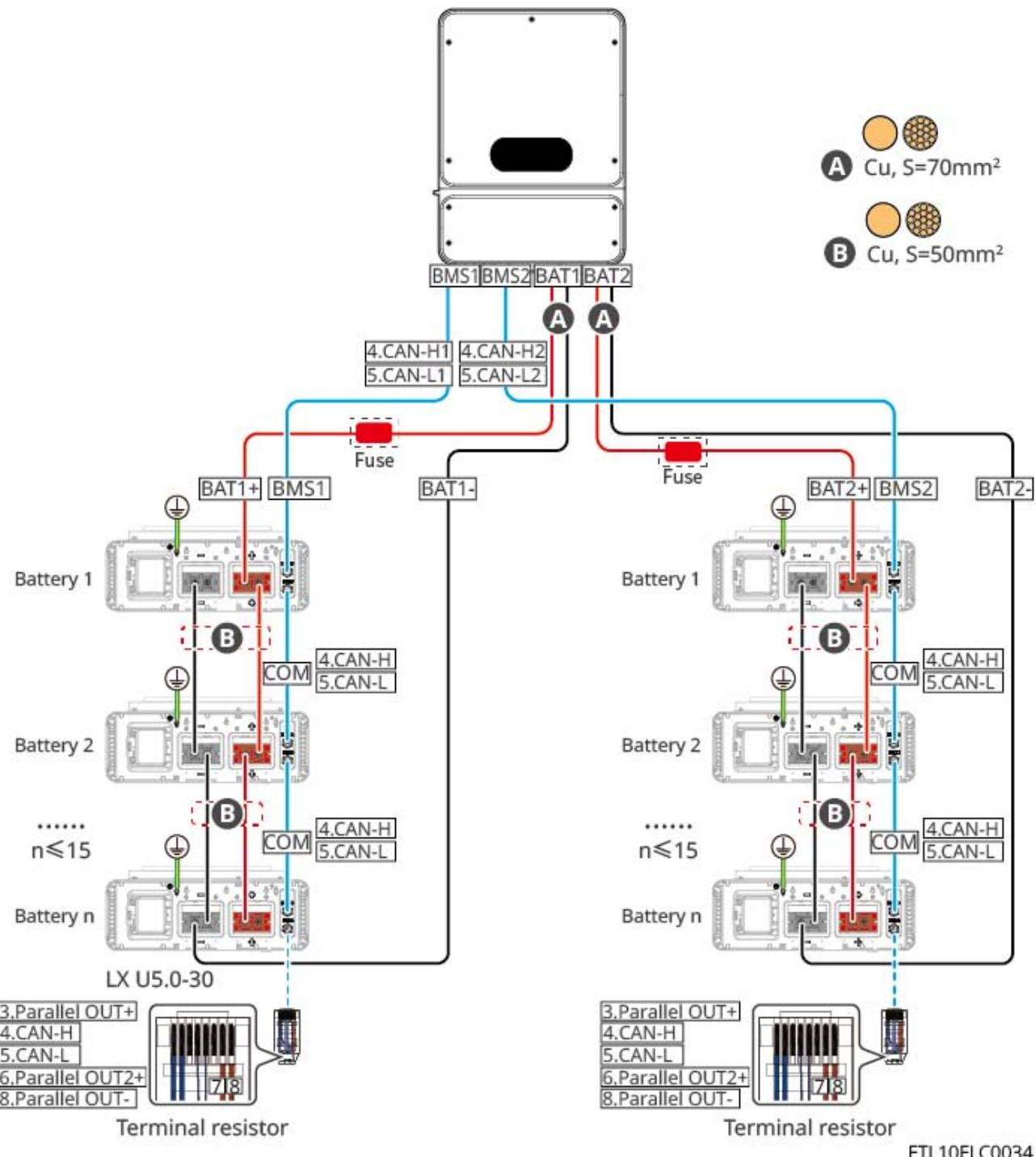
**LX U5.0-30:** Cuando la cantidad de Batería ≤ 6 unidades, Batería se combina con el modo de conexión BCB-22-WW-0.
