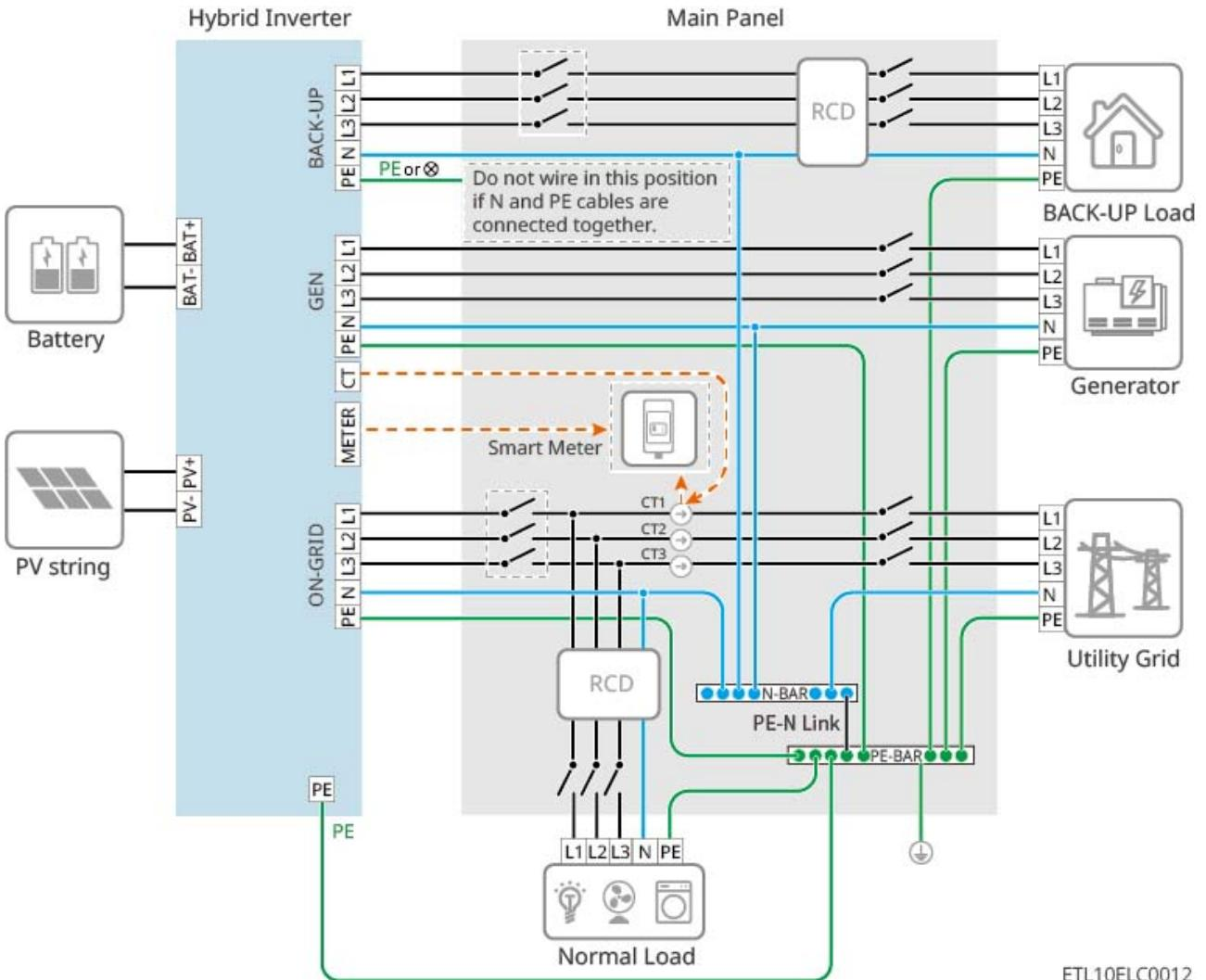
NyPEEI cable se divide en conexiones separadas en el cuadro de distribución.
