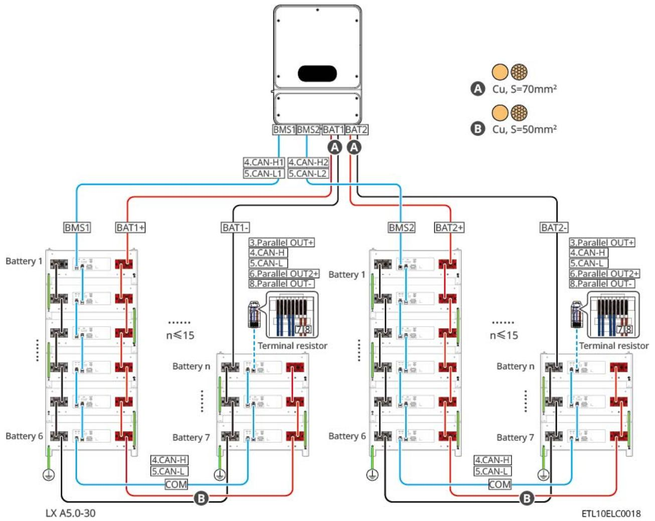
LXA5.0-30: Compatible con el método de conexión de barras colectoras BCB-22-WW-0, el diagrama de conexión es el siguiente:
