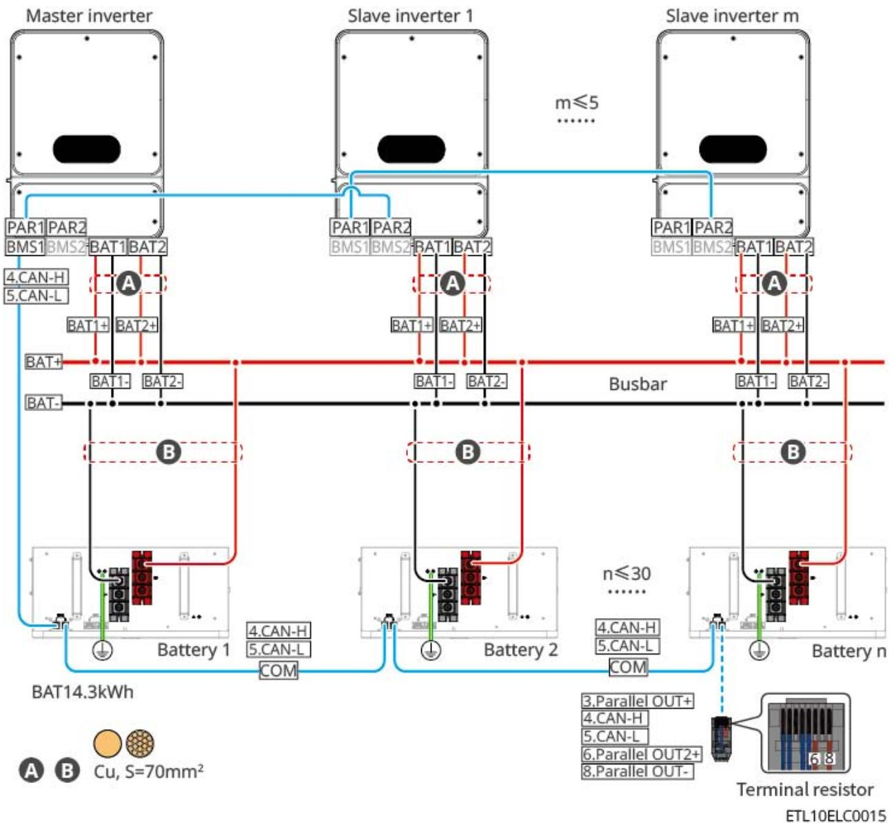
LX U5.0-30: Conexión en cadena (daisy chain), al conectar un solo Batería con salida monofásica Inversor:
